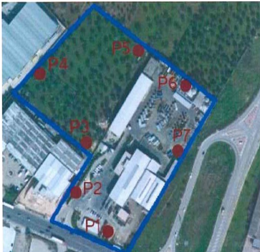
Figura 5: Planimetria delle postazioni delle misure fonometriche relative alla valutazione dell'impatto acustico
